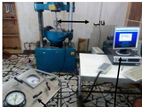
واحد ثبت نیرو - جابجایی واحد ایجاد فشار سیال Fig. 4 HATP experimental test setup
